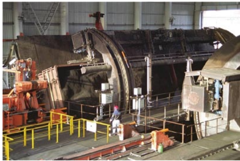
Kuva 5-8. Esimerkki malmikuljetusvaunujen purkupisteestä (lähde: Havator).
