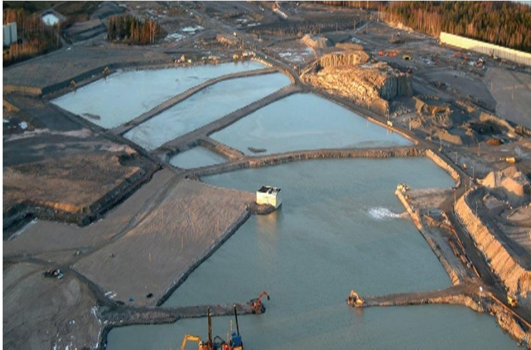
a) Massastabilointialtaat Vuosaaren satamassa (lähde: Vuosaaren satama), b) massastabilointi käynnissä Valencian satamassa (lähde: ALLU).
