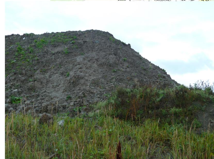
Ylijäämäsavea, jossa seassa pilaristabiloitua savea, varastokasalla Vuosaarella (2011)
