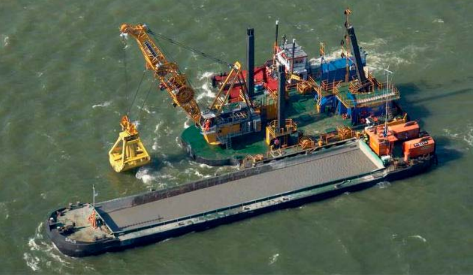
Kuva 4-5 Terramare Oy:n Kahmari2 kahmariruoppaaja, jossa suljettu kauha ympäristöruoppaukseen.
