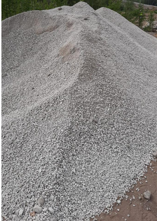
Kuva 3. Kalkkikivikasa, jossa karkeampi rakeinen murske jaottunut ulkoreunoille.
