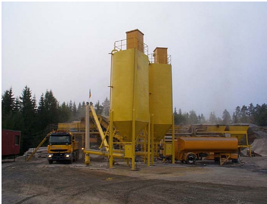
Kuva 8: Materiaalien sekoitusta asemasekoittimella. Kukkia Circlet, Pilot 2002
