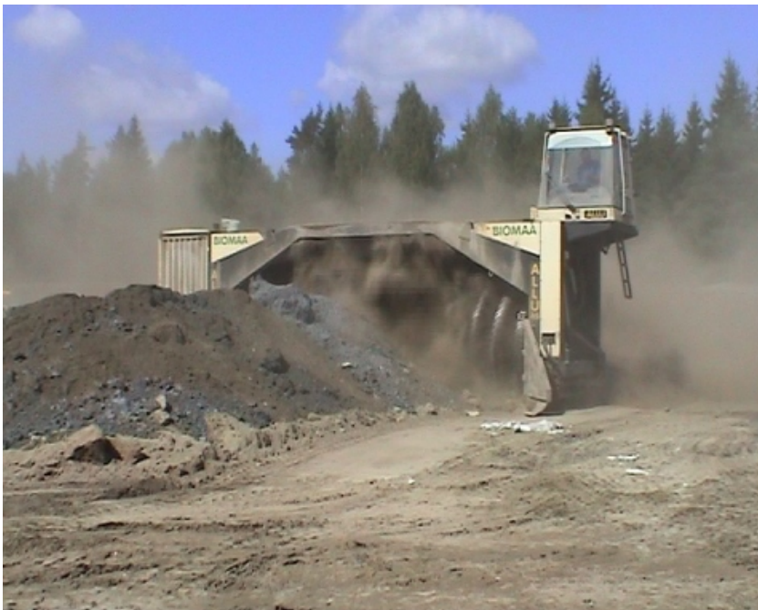
Kuva 9B: Kuitutuhkan sekoittamista aumasekoittimella. Kukkia Circlet
