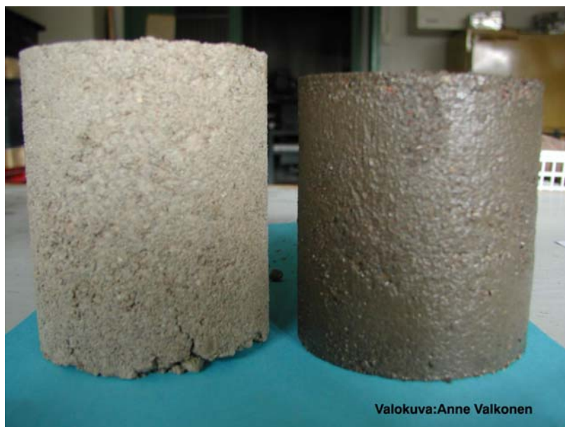
Kuva 3: Soramurske Aitoo 0/12 mm (vas) ja soramurskeen lisäksi 6 paino-%:ia kuivaa suotokakkua sisältänyt kappale (sama massamäärä, sama tiivistystyö määrä, kappaleiden halkaisija 100 mm.). Kuva: TTY / Anne Valkonen
