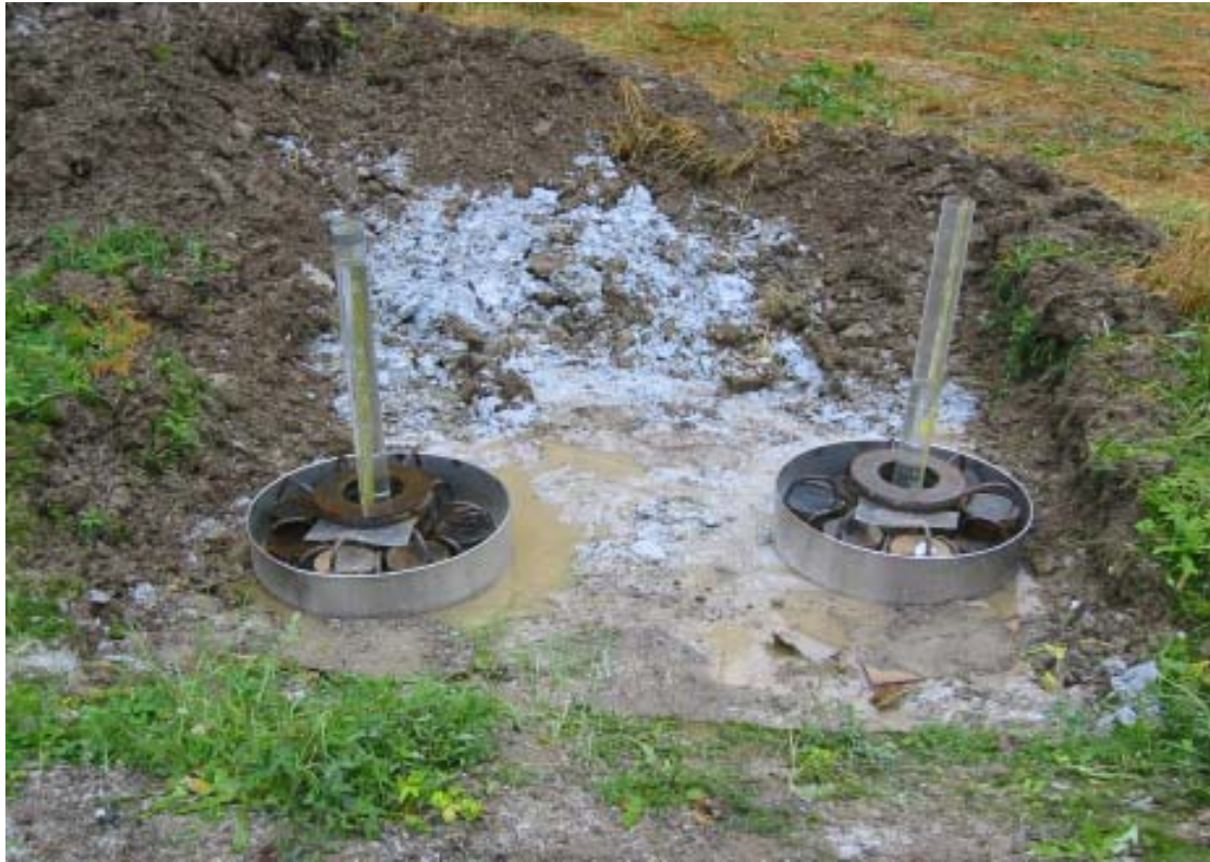
Kuva 15. Pilot 2003. Pihtisalmentie (Pt 13981). Luiskasuojarakenteen infiltrimetrimittaukset syyskuussa 2004.
